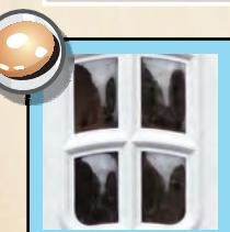
**Vypouklá skla** - tato skla jsou zhotovena prohnutím skla (probarveného ve hmotě) za tepla do požadovaného tvaru. V konečném výrobku tvoří vypouklé sklo vnější stranu izolačního dvojskla ve dveřní výplni. Vnitřní strana izolačního dvojskla může být tvøzena libovolným sklem (ornamentním, reflexním atd.) z nabídky výrobce.
